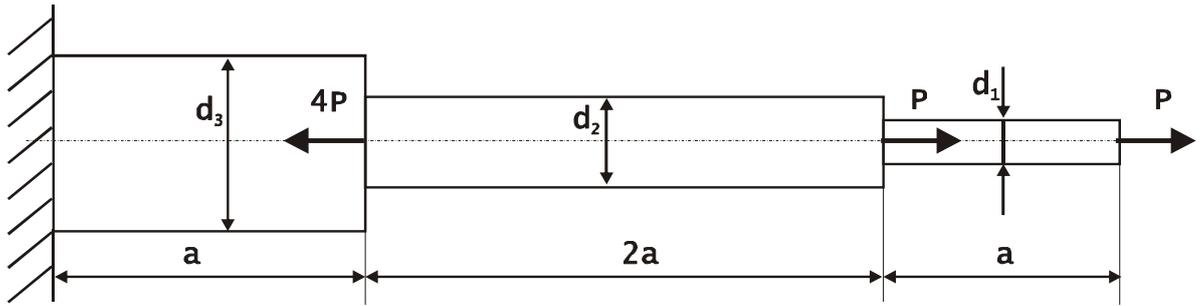
2. Пример задачи к контрольной работе № 2 «Расчет на прочность или жесткость статически определимой балки». Содержит 1 задачу (максимальная оценка 10 баллов).
