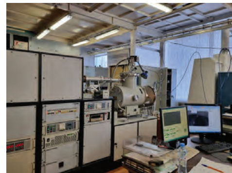
Изучение управляемой полимеризации на геротронном излучателе СВЧ, частота 24ГГц
