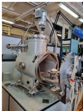
Изучение управляемой полимеризации на геротронном излучателе СВЧ, частота 24ГГц
