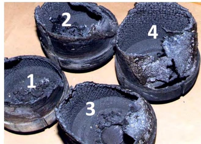
Образцы коксового остатка ЭС, содержащей штатный наполнитель (1,2,3) и наночастицы гидроксида магния и ПФА (4).
