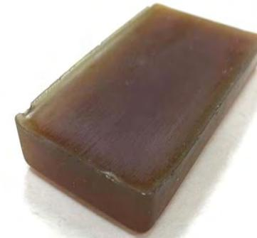
Образец композиционного наноматериала полиэфирной смолы, содержащей воду и 5% наночастиц ZnO (50 нм)
